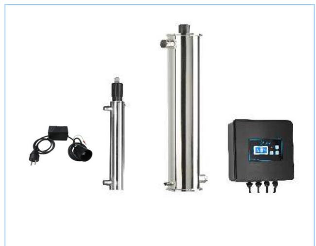
Tutti i nostri apparecchi hanno una camera di sterilizzazione in acciaio inox (Aisi 304L o 316L). Le lampade sono immerse, all'interno della camera di disinfezione, nel fluido da trattare e sono separate da esso da pareti di quarzo che sono trasparenti ai raggi UV-C al 98 %. La camera di disinfezione è ispezionabile da entrambi i lati. La durata media delle lampade è di circa 8000 ore di funzionamento e la loro accensione è protetta da un filtro elettronico.
