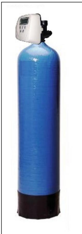
I filtri della serie small - medium, vengono realizzati con contenitore in resina poliestere rinforzata con fibra di vetro. Le cariche filtranti sono costituite da quarzite selezionata a diversa granulometria, da letto catalitico deferrizzante, o da carbone attivo granulare.
